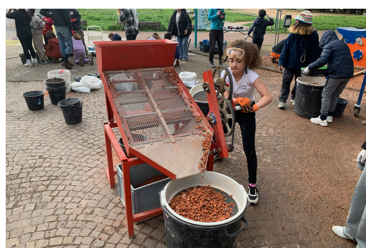
Récupération des briques rouges, concassage et tamisage lors des Ateliers Marbre d'ici / Place Rouge, 2025
