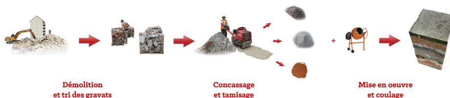
*Marbre d'ici* est un béton produit localement à partir du recyclage des gravats issus des démolitions d'immeubles. Réduits en poudre, mélangés à du ciment et coulés en strates, les déchets du BTP sont transformés en une matière noble – une nouvelle ressource pour la construction, l'aménagement d'espaces publics ou le design.
