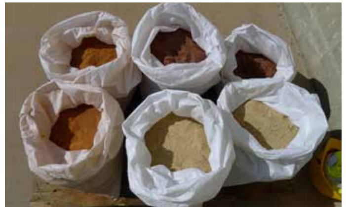
Gravats réduits en poudre
